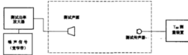
图 11 用模拟自然声源进行混响时间测量的原理框图
