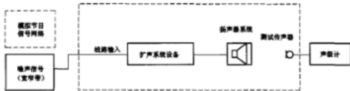
图3 电输入法测量传输频率特性原理框图
